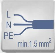
3. In der Versorgungsanlage sind Leitungen mit dem Querschnitt von mindestens  $1,5 \text{ mm}^2$  zu verwenden.
