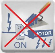
8. Über die Zeitdauer der Fertigstellungs-, Bau - oder Sanierungsarbeiten sind die Antriebe freizuschalten, so dass diese gegen plötzliche Spannungssprünge in der Anlage geschützt werden.
