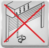
**! DIE FUNKTION DES NOT-HANDANHEBENS NICHT VERWENDEN, SOFERN DER MOTOR UNTER SPANNUNG BLEIBT !**
