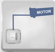
5. Die Leitungsantriebe sind so anzuschließen, dass an einen Schalter nur ein Antrieb geschlossen ist.
